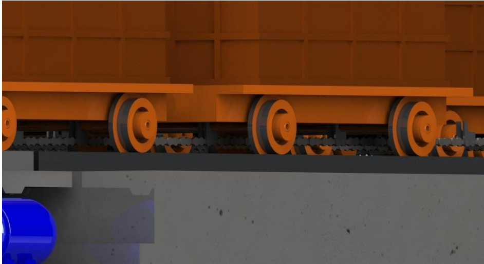
Figura 16 - Detalhe da corrente transportadora.
