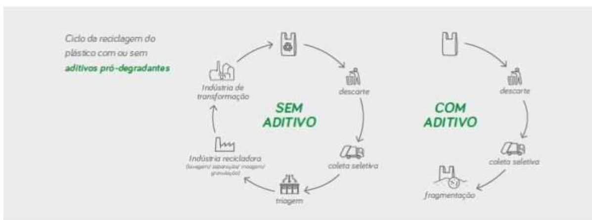
Figura 2: Ciclo da reciclagem do plástico com ou sem aditivos pró-degradantes. FONTE: Abiblast (2014).
