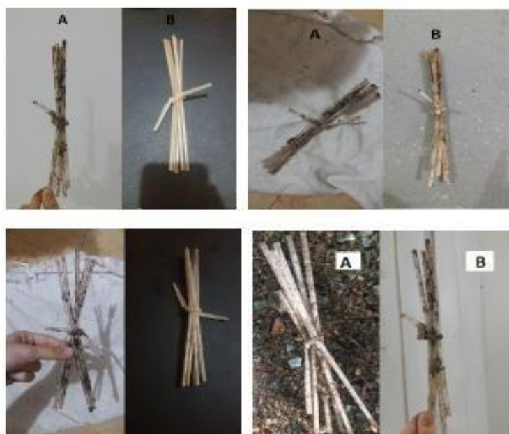
Figura 9: Canudos extraídos após 30,60,90 e 120 dias em Medianeira-PR. FONTE: O autor (2019).
