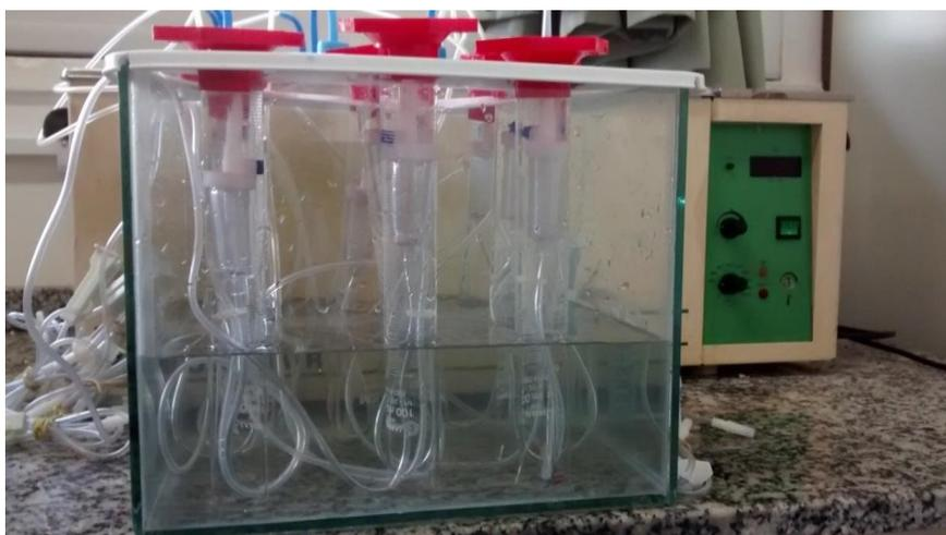
Figura 4 – Sistema do Biorreator montado para testes
