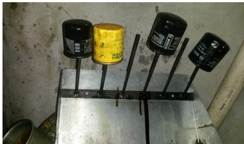
Figura 7- escoamento dos resíduos oleosos
