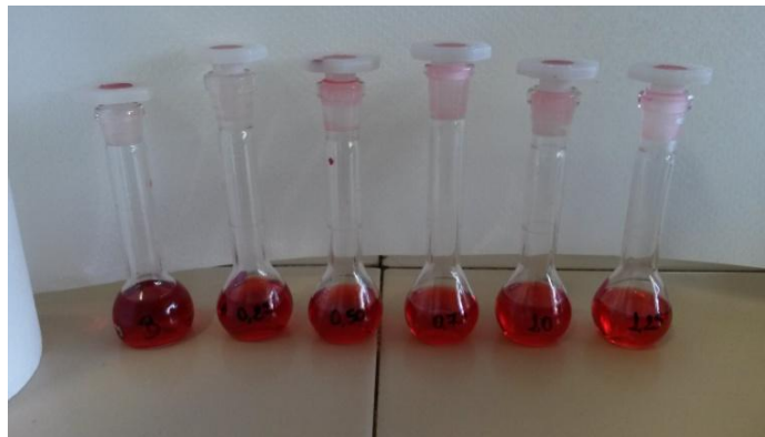
Figura 9: Cor apresentada pelo método de determinação de fluoreto em diferentes concentrações. Fonte: Autor.
