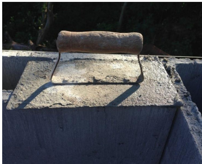
Figura 12- Exemplo de palheta ferramenta que distribui a argamassa, 2016
