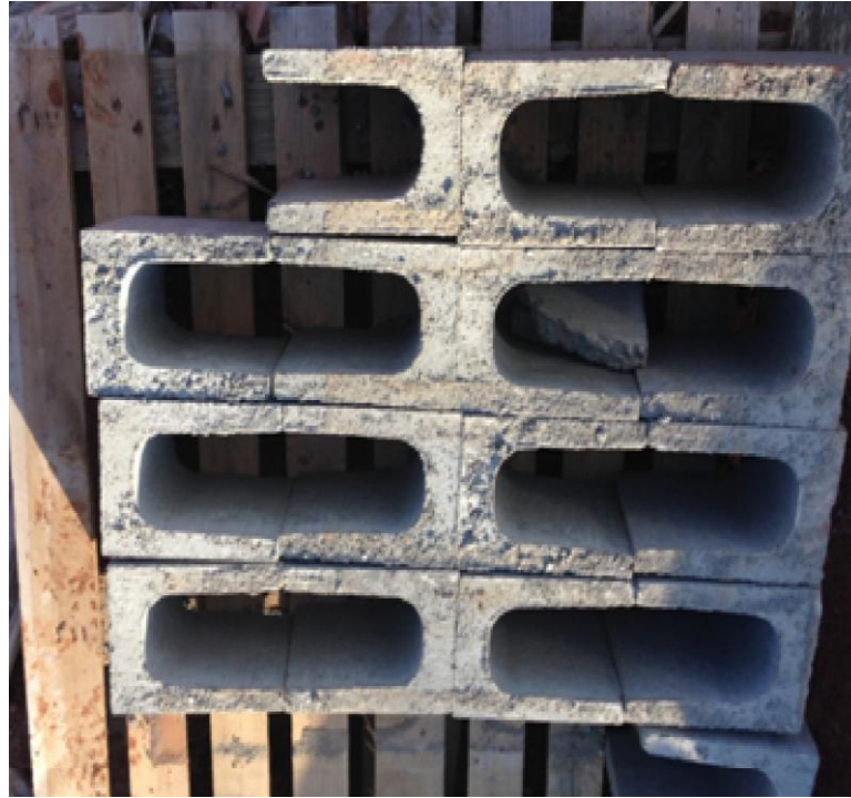
Figura 10- Imagem dos blocos canaletas, 2016.
