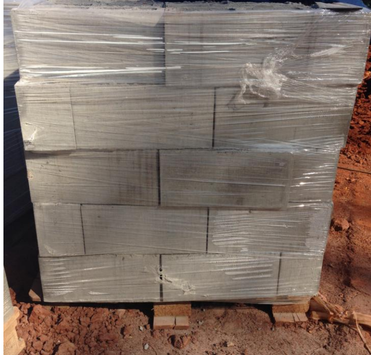
Figura 9- Distribuição dos blocos de concreto sobre os paletes, 2016
