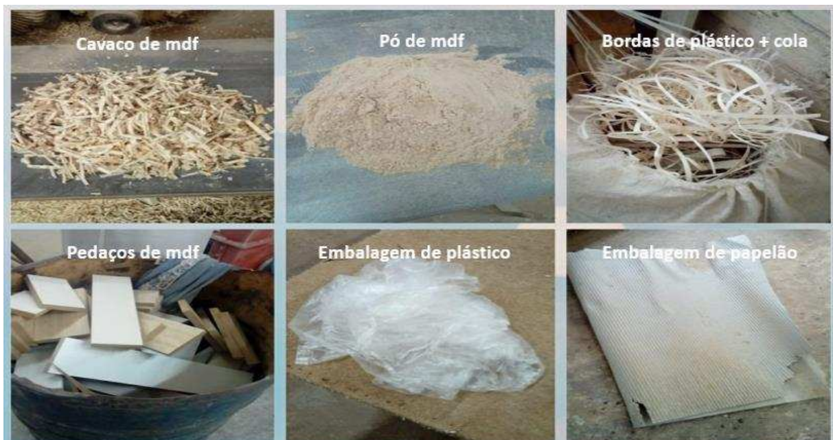
Figura 3: Resíduos gerados na fabricação de móveis em MDF; Fonte: Elaborado pela autora.
