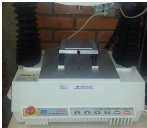
**Figura 14-** Texturômetro *Stable Micro Systems*, TA.HD.Plus, Godalming, UK, utilizado na análise do perfil de textura.
