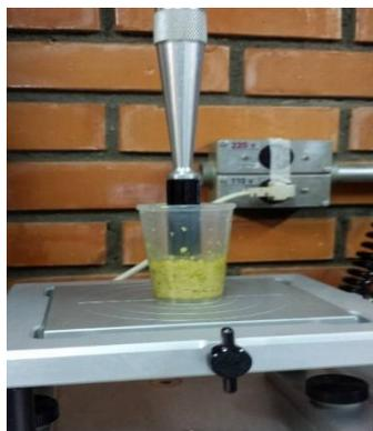
**Figura 16- Probe Cylinder Derlin Radiused, durante a medição da textura.**
