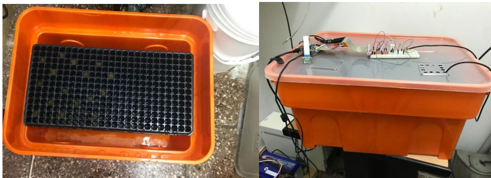
Figura 35 - Sistema adaptado para crescimento e controle de umidade e temperatura. Fonte: pesquisa de campo.
