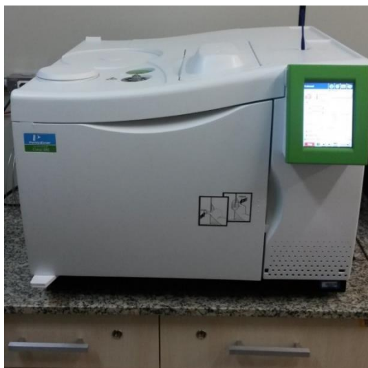
Figura 13 - Cromatógrafo PerkinElmer Clarus 680.
