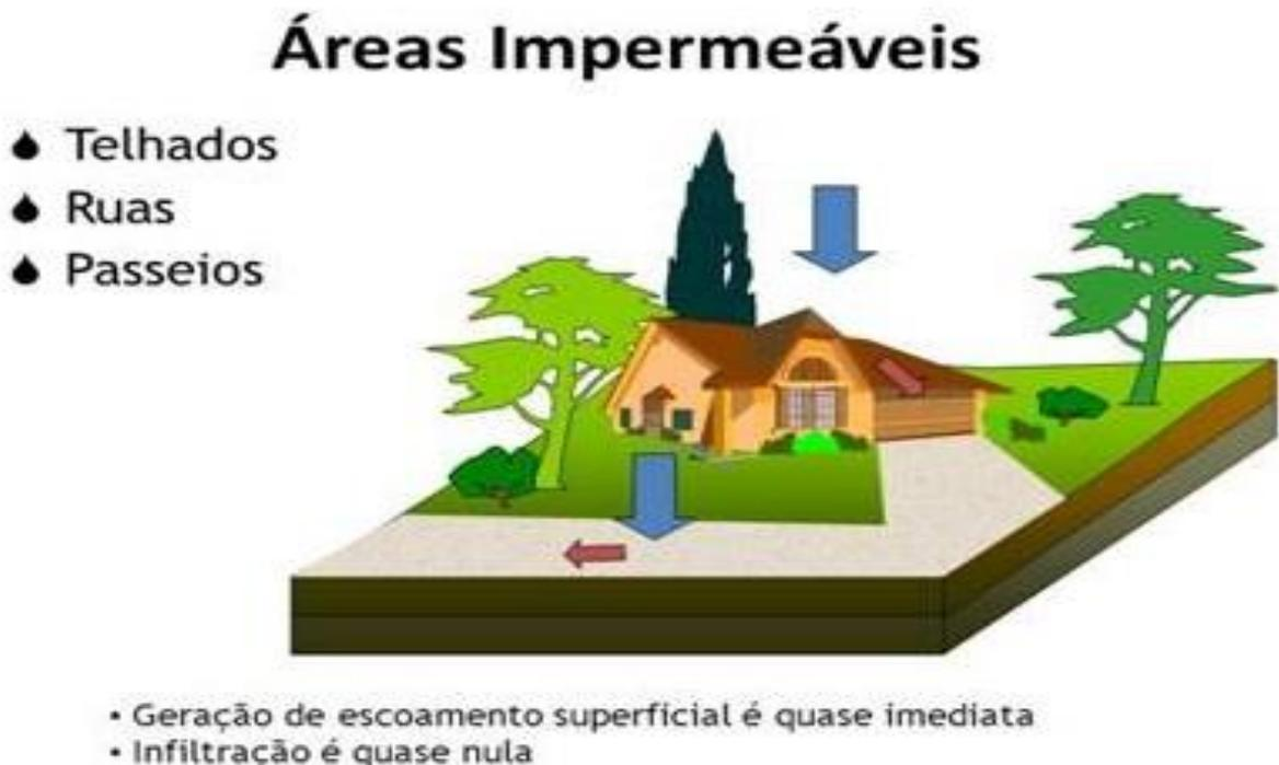
Figura 2: Exemplo do ciclo hidrológico em área impermeabilizada.
