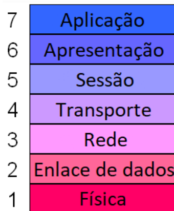
Figura 2 – Camadas do modelo OSI. Adaptado de: (TORRES, 2014).
