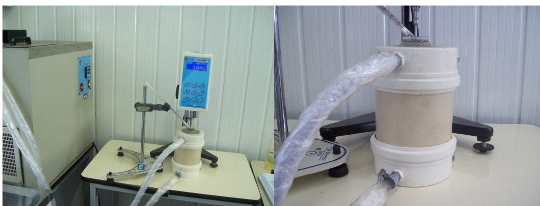
Figura 5 – Fotografia do Viscosímetro da marca Quimis com porta amostra acoplado ao banho termostático, desenvolvido pelo grupo de pesquisa de fluidos complexos da UTFPR.
