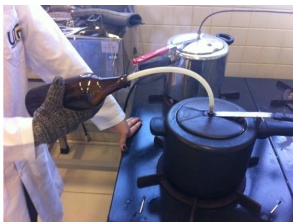
Figura 6. Fotografia do procedimento de esterilização das garrafas por injeção de vapor.
