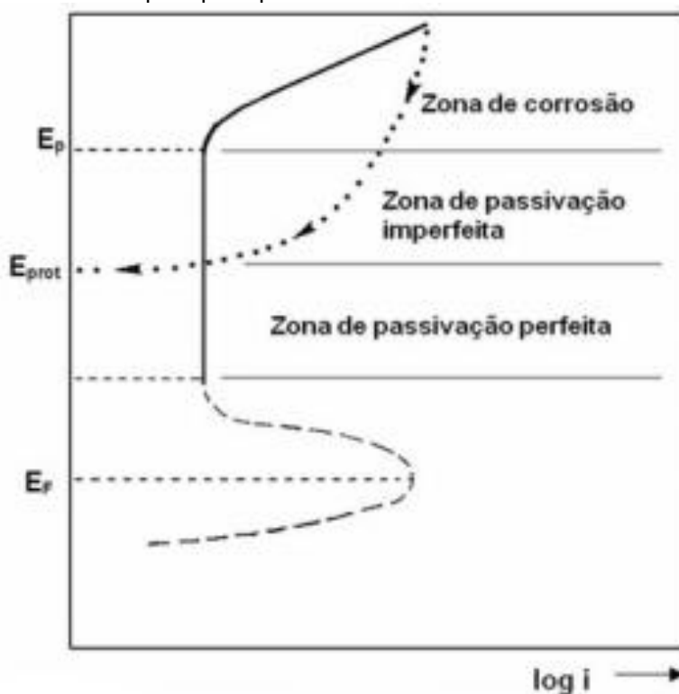
Figura 7: Curva de polarização esquemática ilustrando as condições sob as quais pites podem ou não ocorrer.
