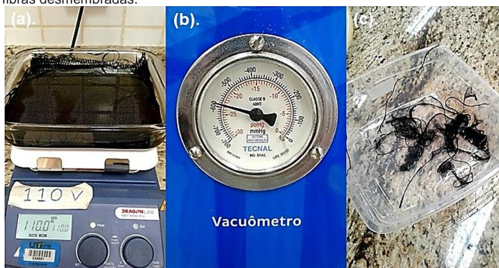
Figura 19 – Processo de tratamento oxidativo: (a). imersão dos tecidos de fibras de carbono no ácido nítrico; (b). valor do vacuômetro da estufa à vácuo; e (c). fibras desmembradas.
