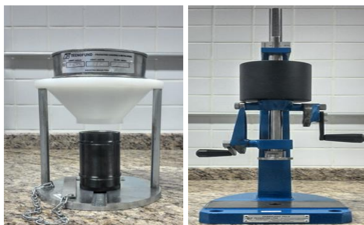
Figura 24 – Conjunto de equipamentos utilizado para compactabilidade. Fonte: Autoria Própria.
