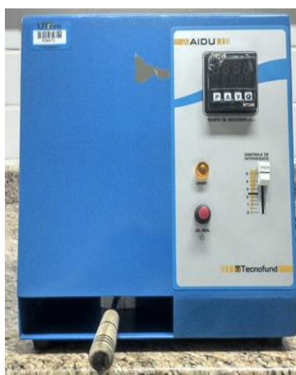
Figura 18 - Secador por luz infravermelho, modelo AIDU. Fonte: Autoria própria.
