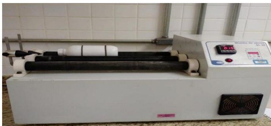
Figura 22 - Sistema de mistura da areia a verde Fonte: Autoria Própria.
