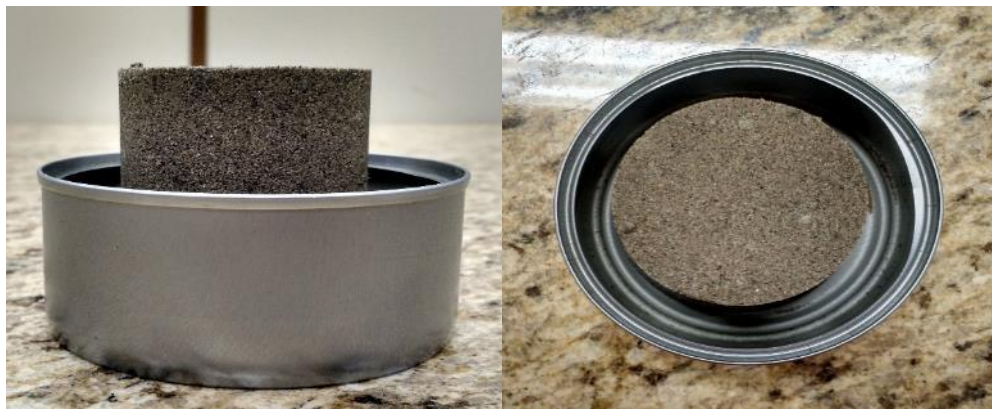
Figura 27 – Aparato experimental para simulação do processo de oolitização, corpo de prova com 50mm de diâmetro.
