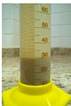
Figura 35 - Inchamento de bentonita após 24 horas. Fonte: Autoria própria.
