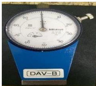
Figura 26 - Durômetro DAV-B, fabricante Tecnofund. Fonte: Autoria própria.
