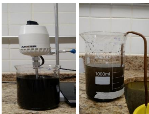
Figura 19 - Sistema de sifonamento manual (agitação a esquerda e sifonamento a direita). Fonte: Autoria Própria.
