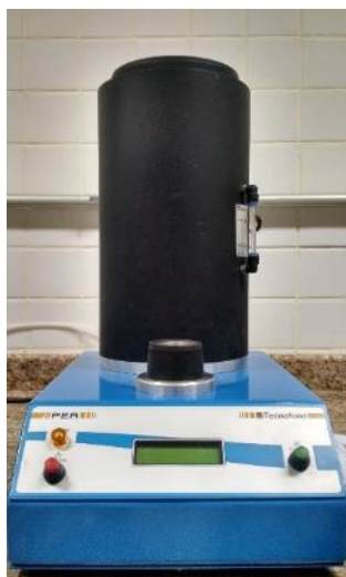
Figura 25 - Permeômetro de areia PERB, fabricante Tecnofund. Fonte: Autoria Própria.
