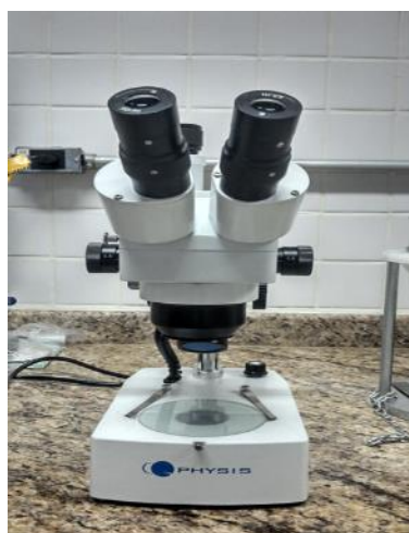
Figura 20 – Estereoscópio, aumento de 40 vezes, fabricante Physis. Fonte: Autoria própria.
