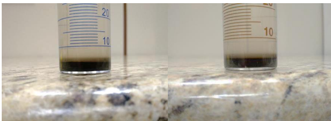
Figura 68 - Resultado após o teste de inchamento dos finos. Fonte: Autoria própria.
