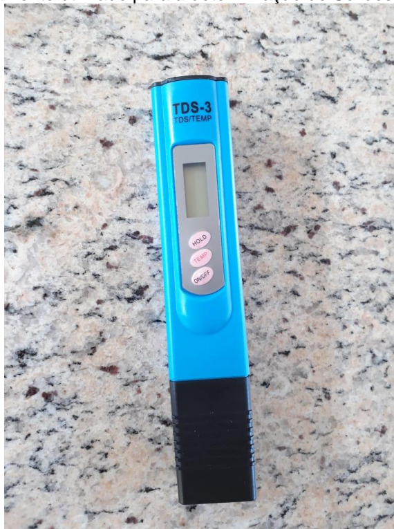
Figura 11: Equipamento utilizado para a determinação de Sólidos Dissolvidos Totais.
