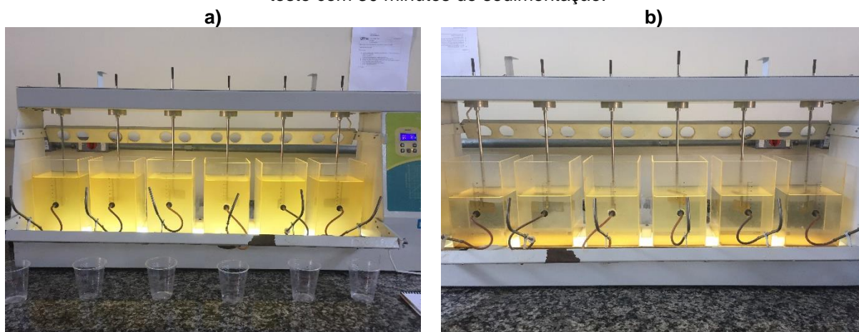
Figura 16: COAGULANTE B - BÁSICO: a) Água bruta (antes do jar teste). b) Amostras depois do jar teste com 30 minutos de sedimentação.
