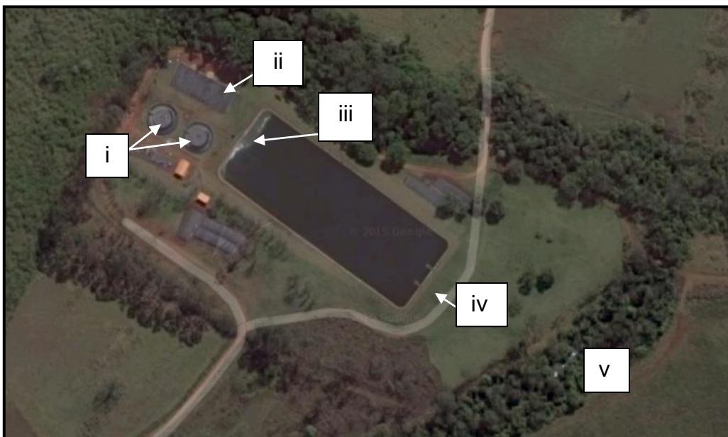
Figura 5: (i) RALFs; (ii) Leitos de Secagem de Lodo; (iii) Entrada Lagoa Facultativa; (iv) Saída Lagoa Facultativa e (v) Mata ciliar do Córrego São Lourenço.
