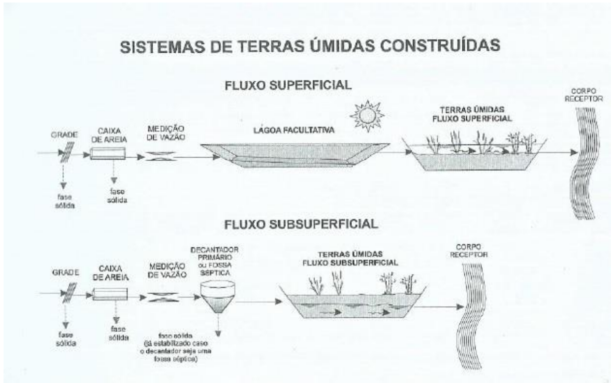
Figura 4 – Fluxos de Sistemas Wetlands Construídos Fonte: Von Sperling (2005).
