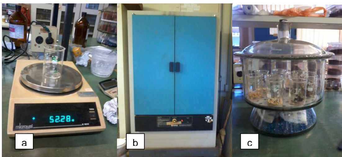
Figura 23 – (a) Balança, (b) estufa ventilada a 105°C e (c) dessecador respectivamente. Fonte: Autoria própria.
