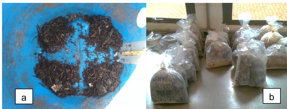
Figura 22 – (a) Amostragem do composto por quartearamento ABNT NBR 10007 (2004), (b) armazenamento das amostras. Fonte: Autoria própria.
