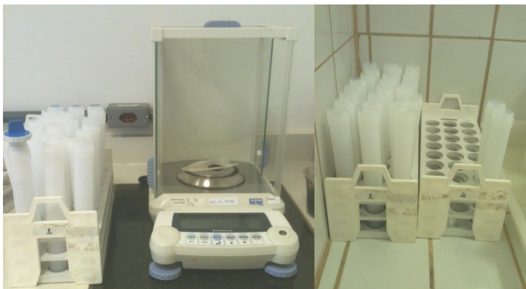
Figura 27 – Balança analítica (e) e tubos de Teflon® em processo de pré-digestão (d) Fonte: Autoria própria.
