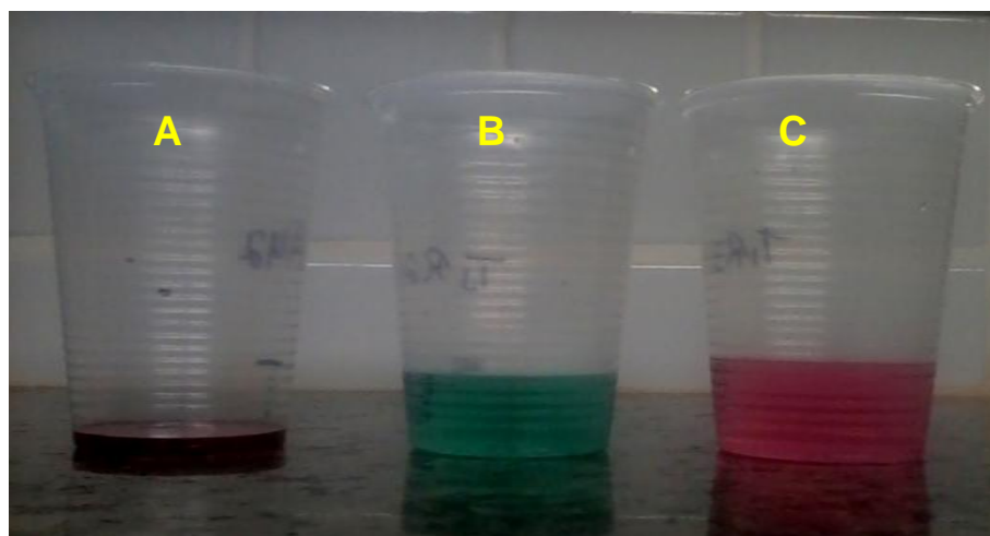
Figura 28 – Diferentes colorações durante as etapas da análise de NTK Nota: A – ácido bórico; B – amostra destilada; C – amostra titulada. Fonte: A autora.
