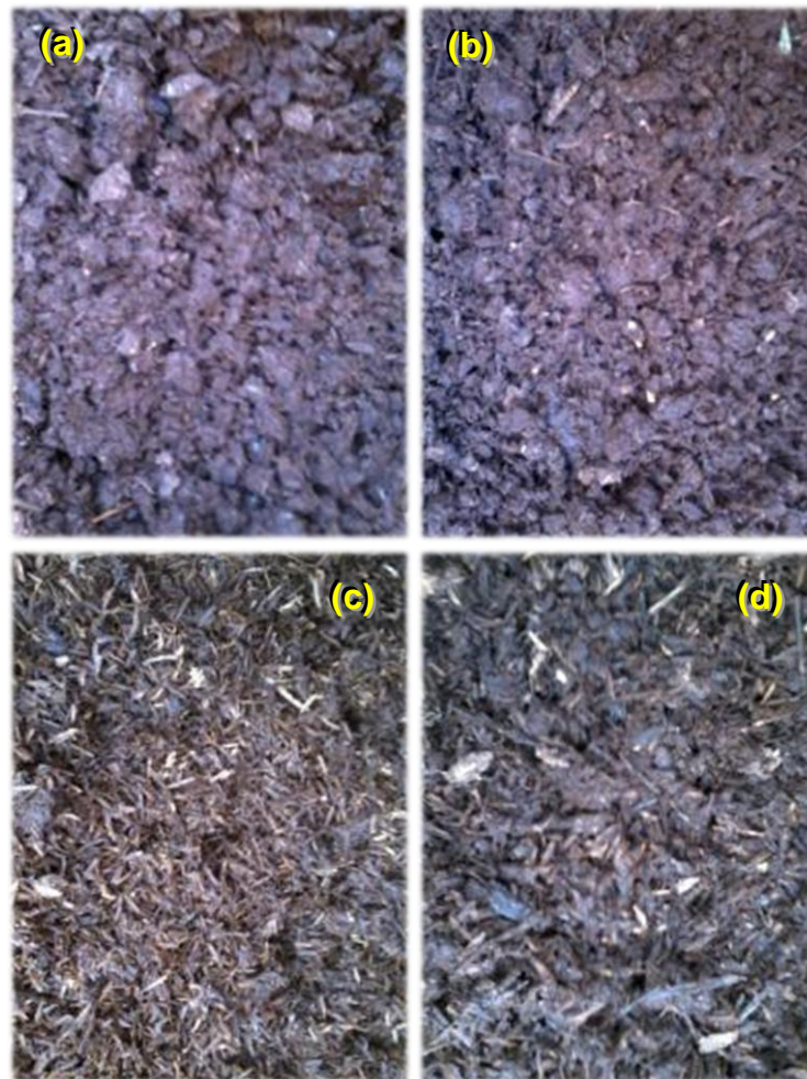
Figura 31 – Aspecto dos resíduos após a vermicompostagem
