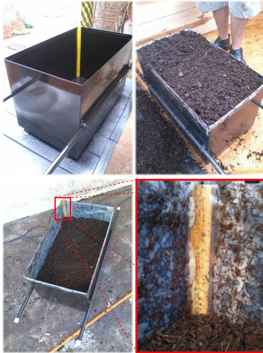
Figura 18 – Determinação do volume na pré-compostagem Fonte: A autora.
