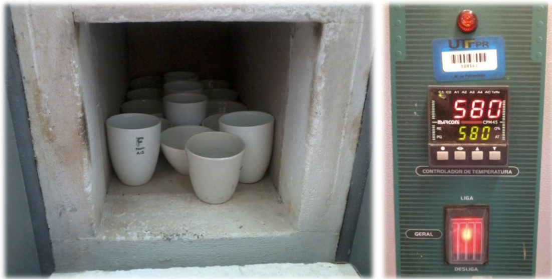
Figura 25 – Material em forno mufla para determinação de sólidos voláteis Fonte: A autora.
