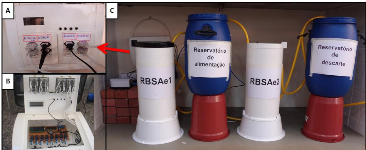
Figura 15 - Instalação experimental: (A) Visão externa do painel de controle e automação, (B) Visão interna do painel de controle e automação e (C) Vista frontal dos reatores e reservatórios de alimentação e descarte. Fonte: Autoria própria.
