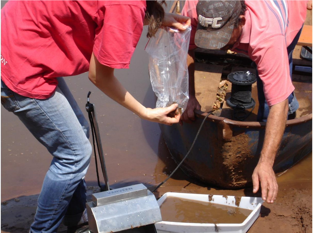
Figura 5 - Retirada da amostra de sedimento do interior da Draga de Van Veen no reservatório Fiú (Bacia do rio Apucarantina).
