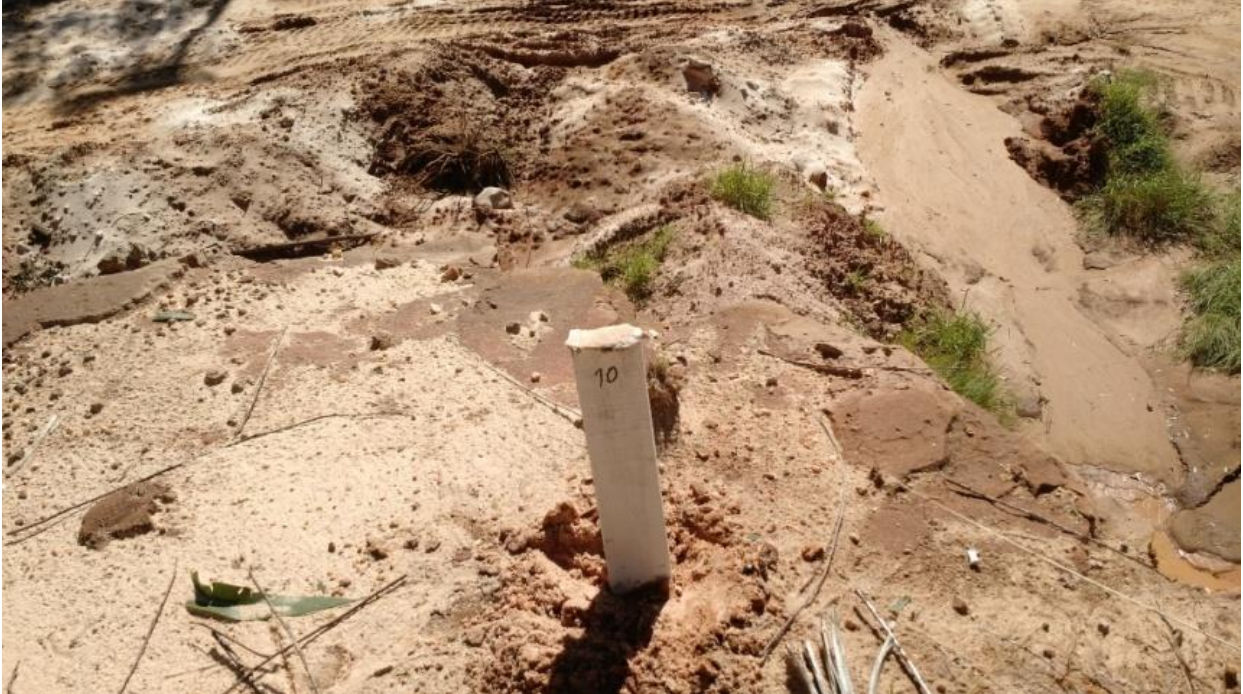
Figura 10– Estaca 10 usada para medir a perda de talude
