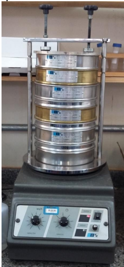
Figura 4 – Agitador e conjunto de peneiras montados usados no ensaio de peneiramento
