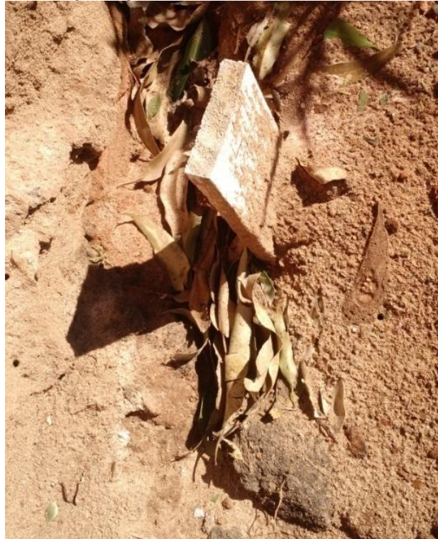
Figura 9 - Formação de sulco na parte posterior da estaca 7
