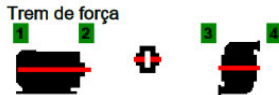
Figura 17 - Posições para prender o sensor magnético Fonte: Fluke 810 Vibration Tester
