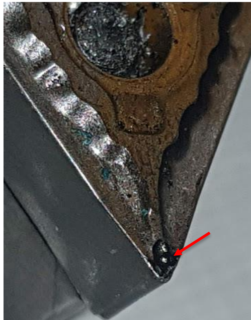
Figura 30 – Desgaste por cratera encontrado na pastilha.
