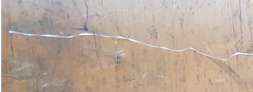
Figura 33 – Forma do cavaco no torneamento com bit.
