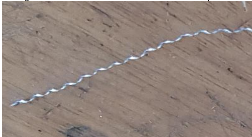
Figura 32 – Forma do cavaco no torneamento com pastilha.
