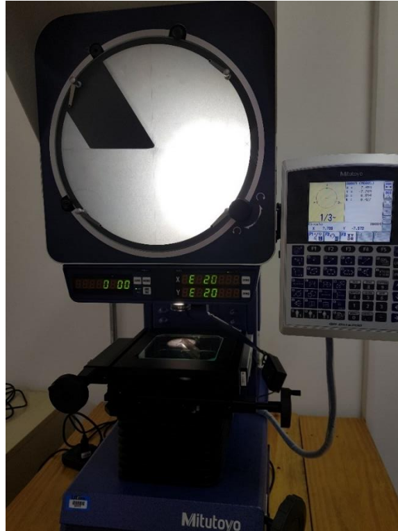
Figura 25 – Medição das dimensões do bit após afiação
