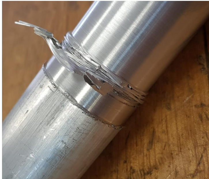
Figura 34 – Deformação do cavaco em altas rotações na usinagem com bit.
