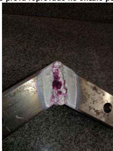
Fotografia 8 – Corpo de prova reprovado no ensaio por líquidos penetrantes.
