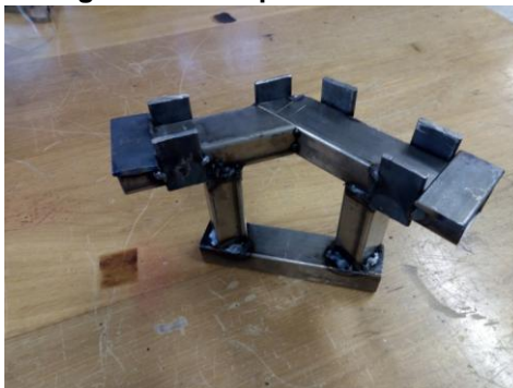
Fotografia 4 – Dispositivo de solda.
