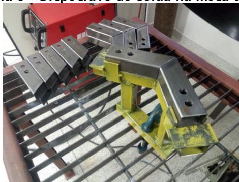
Fotografia 5 – Dispositivo de solda na mesa de solda.
