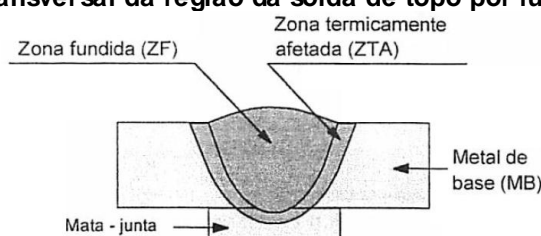
Figura 7 – Seção transversal da região da solda de topo por fusão (Esquemático).
