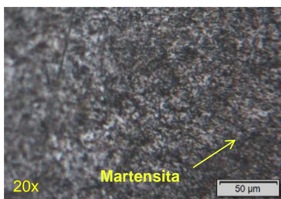
Figura 10 – Microscopia da amostra 2 - região do cordão de solda com ampliação de 20x. Fonte: Autoria própria.
