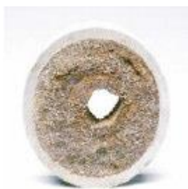
Figura 1: Exemplo de uma linha bloqueada por deposição de parafinas Fonte: Cortesia do CENPES / Petrobras.
