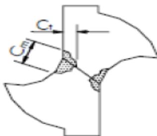
Figura 8 – Desgaste de gume transversal
