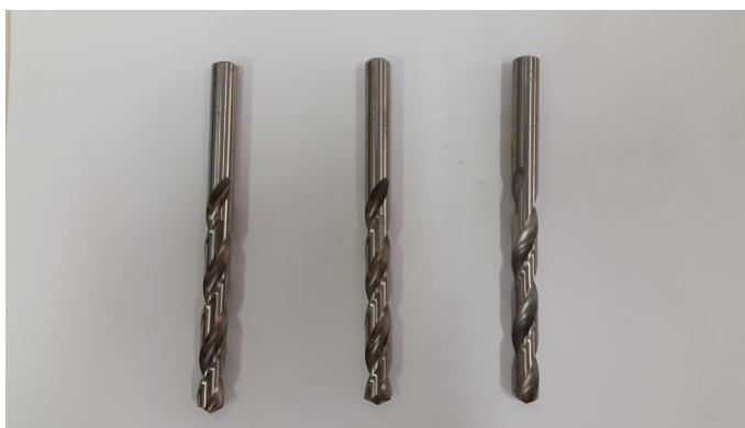
Figura 13 – Ferramentas utilizadas com diferentes ângulos de ponta (100°, 120° e 140°)
