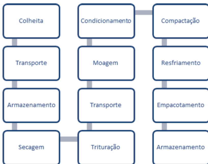
Figura 11 - Etapas do processo de peletização e briquetagem Fonte: DIAS et al., 2012.
