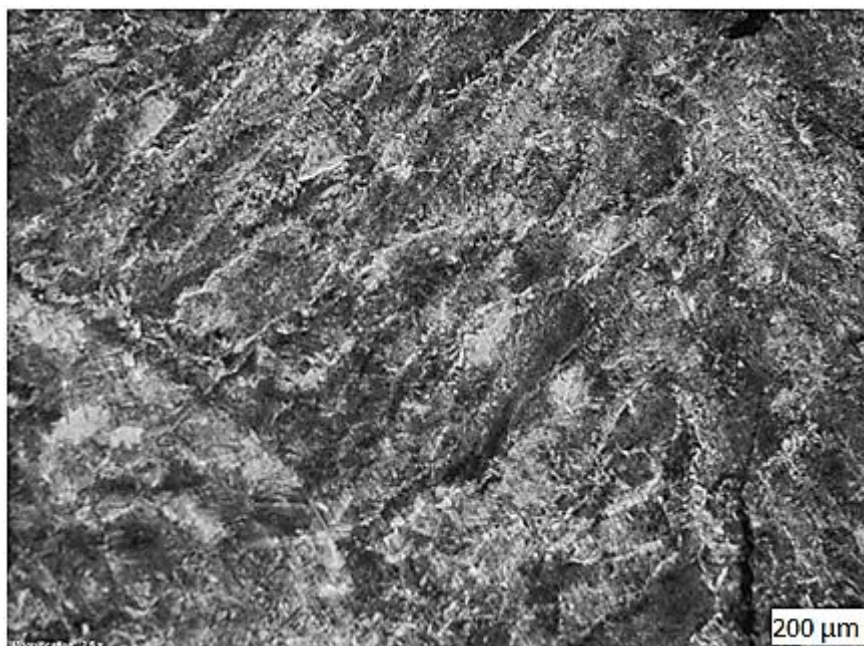
Figura 25 - Micrografia com ampliação de 5 X do cordão de solda Fonte: Autoria própria.
