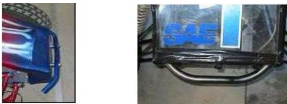
Figura 1 - Exemplos aceitáveis de Pontos de Reboque Dianteiro Fonte: Regulamento Baja SAE Brasil, Capítulo 5 (2016).
