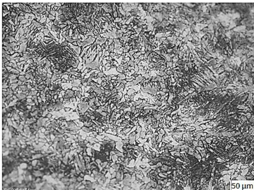
Figura 28 - Micrografia com ampliação de 20 X da Zona Termicamente Afetada Fonte: Autoria própria.
