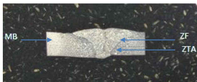
Figura 22 - Amostra do cordão de solda embutido em baquelite Fonte: Autoria própria.
