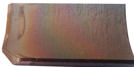
Figura 7 - Amostra pronta para anodização Fonte: autoria própria
