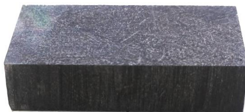
Figura 8 - Amostra utilizada para medir a espessura do revestimento Fonte: autoria própria
