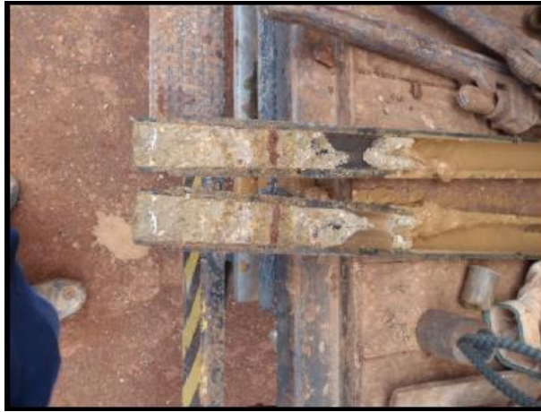
Figura 2 – Amostrador padrão bipartido utilizado no SPT
