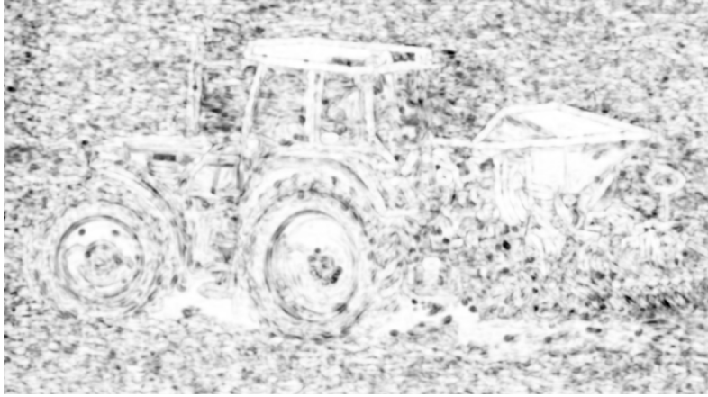
Figura 15: Mapa de estrutura de similaridade de um quadro da sequência de vídeo 'tractor' da base de dados LIVE.
