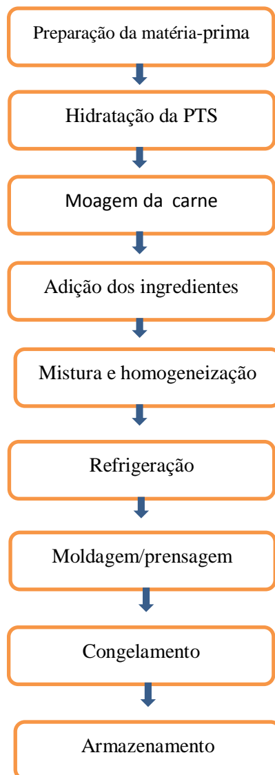
Figura 1: Fluxograma com as etapas de fabricação do hambúrguer. Fonte: HAUTRIVE, 2008.
