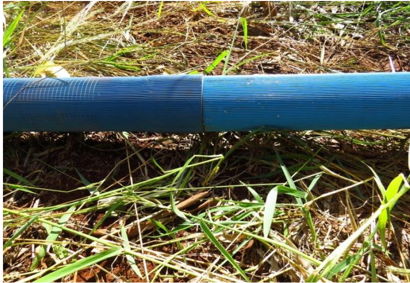
Figura 4: Junção entre o Revestimento e filtro
