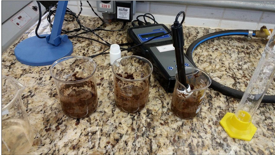
Figura 4: Medição do pH.
