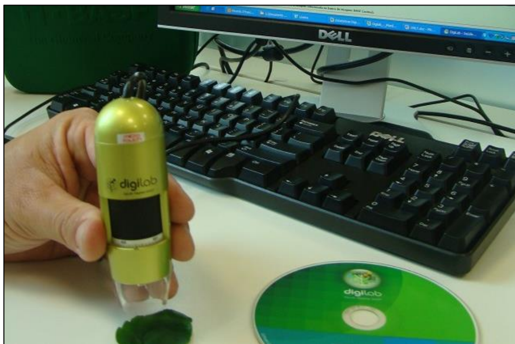
Figura 8 – Microscópio estereoscópio com capacidade de 200x e software, contendo chaves de identificação e imagens de insetos-praga e doenças, utilizado na identificação de insetos-praga Fonte: Do autor (2016).
