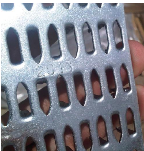
Figura 2: dispositivo anti-racha com identificação Fonte: VLI, 2013.
