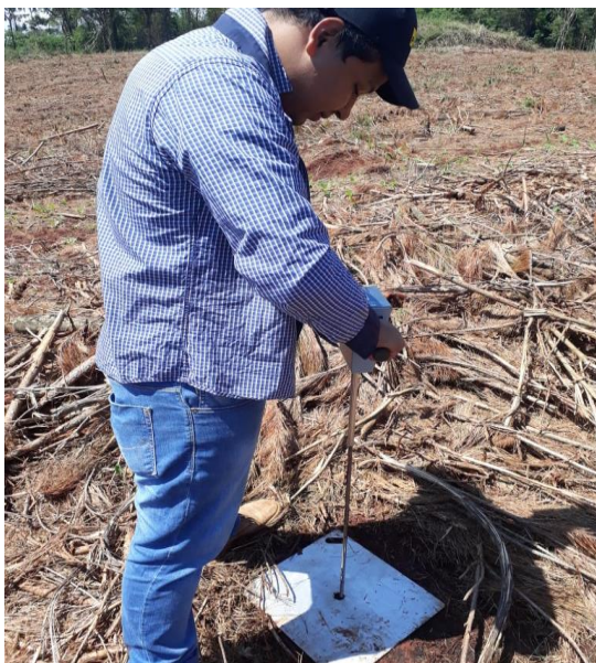
Figura 12 – Medição de Resistencia do solo a penetração. Fonte: O autor, 2018.
