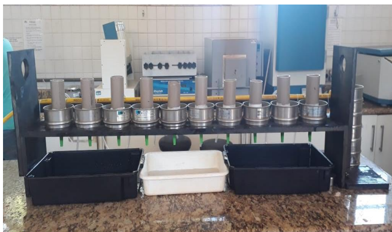
Figura 11- Permeâmetro de carga constante. Fonte. O autor, 2018.
