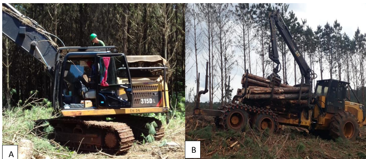
Figura 7- Maquinas utilizadas na colheita florestal. (A) Harvester ; (B) Forwarder . Fonte: O autor, 2018.
