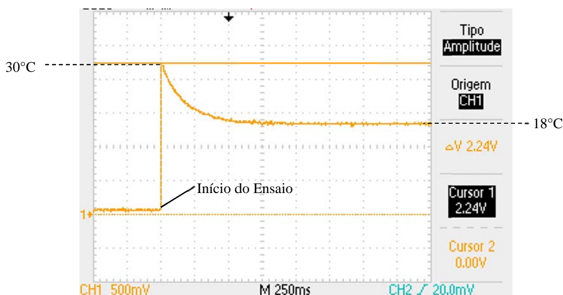
Figura 60 - Resultado do osciloscópio para o modelo de temperatura ambiente.
