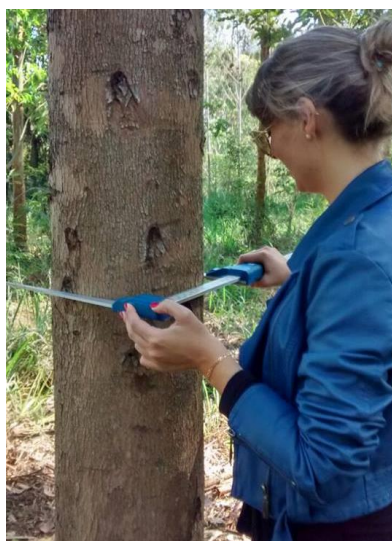
Figura 1: Obtenção do DAP com suta Fonte: O Autor (2015)
