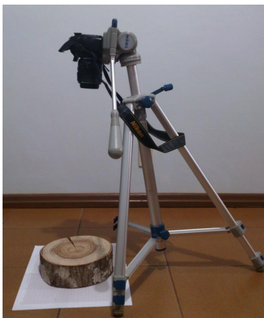
Figura 4: Obtenção das imagens dos discos de madeira de Hovenia dulcis na metodologia digital Fonte: O Autor (2014)
