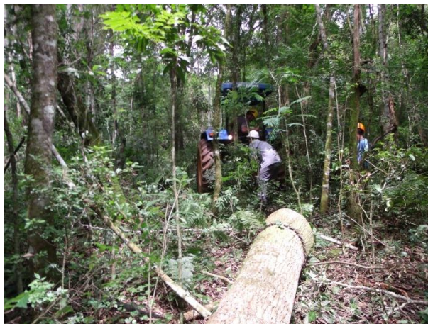
Fotografia 5 - Trator dentro da mata realizando o baldeio. Fonte: O autor (2014).
