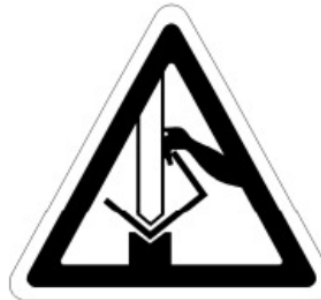
Figura 24 – Risco de esmagamento entre devido à conformação da chapa.
