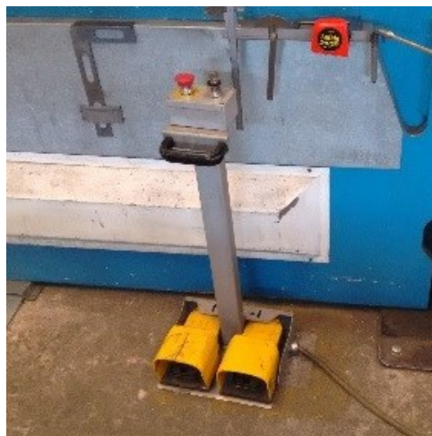
Figura 27 – Dispositivo com pedais de acionamento e botão de emergência em uso.
