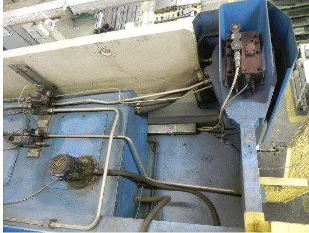
Figura 30 – Sistema hidráulico da máquina, na parte superior.
