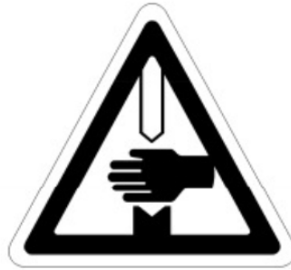
Figura 23 – Risco de esmagamento entre ferramentas.
