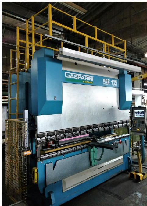
Figura 20 – Dobradeira hidráulica em que foi realizado o estudo de caso.
