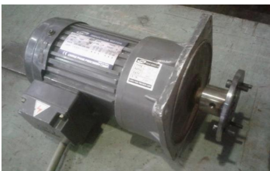
Figura 4.5 – Motor trifásico com redução utilizado no Moizinator e suas especificações
