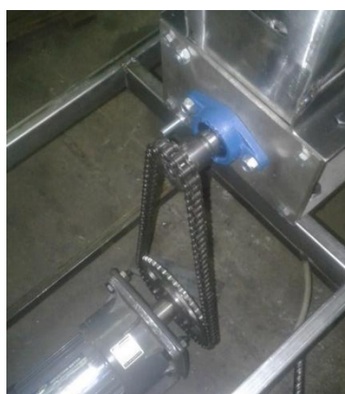
Figura 4.6 - Sistema de transmissão por corrente do motor para o eixo da unidade de trituração
