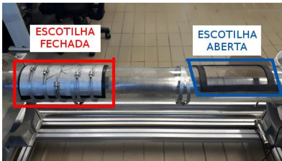
Figura 20 - Escotilhas da Tubulação de Acrílico (fechada e aberta) FONTE: Autoria Própria
