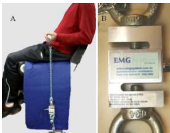
Figura 9 – A – Posicionamento do participante na cadeira com encosto ajustável com a célula de carga adaptada; B – Em detalhe a célula de carga utilizada.
