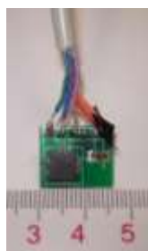
Figura 8 - Sensor de mecanomiografia com acelerômetro desenvolvido por Nogueira-Neto et al. (2008a).
