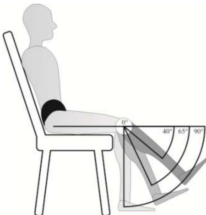
Figura 18 – Modelo esquemático da cadeira extensora com o ângulo inicial de joelho (90°), ângulo para a determinação da tensão (40°) e o ângulo limite para a finalização da EENM (65°).
