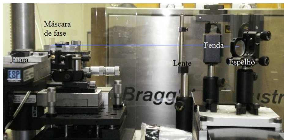
Figura 47 - Foto detalhada do sistema de gravação de FBGs.
